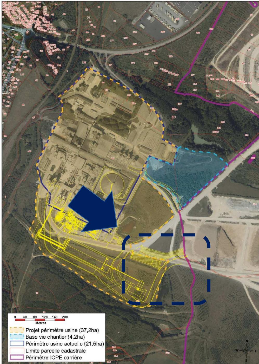
Figure 27 : zone d'implantation des ouvrages de gestion des eaux pluviales imposée par HTC
