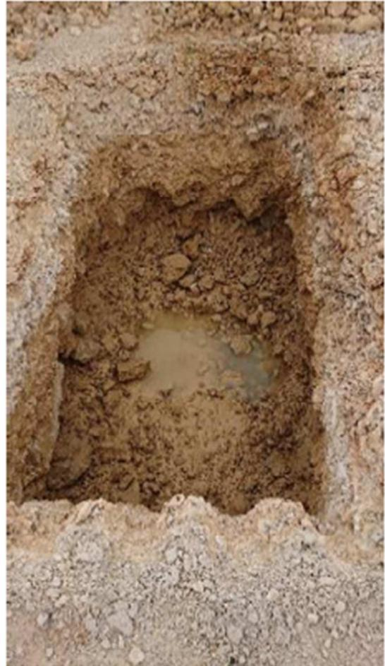
Figure 31 : vue des sondages (après tests d'infiltration d'où la présence d'eau au fond)
