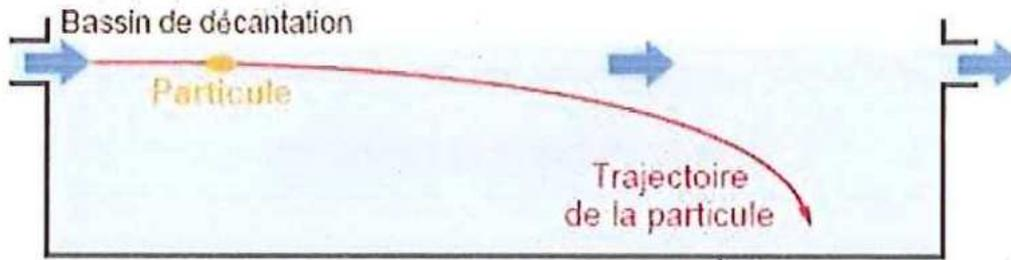
*Schéma d'un décanteur horizontal*
