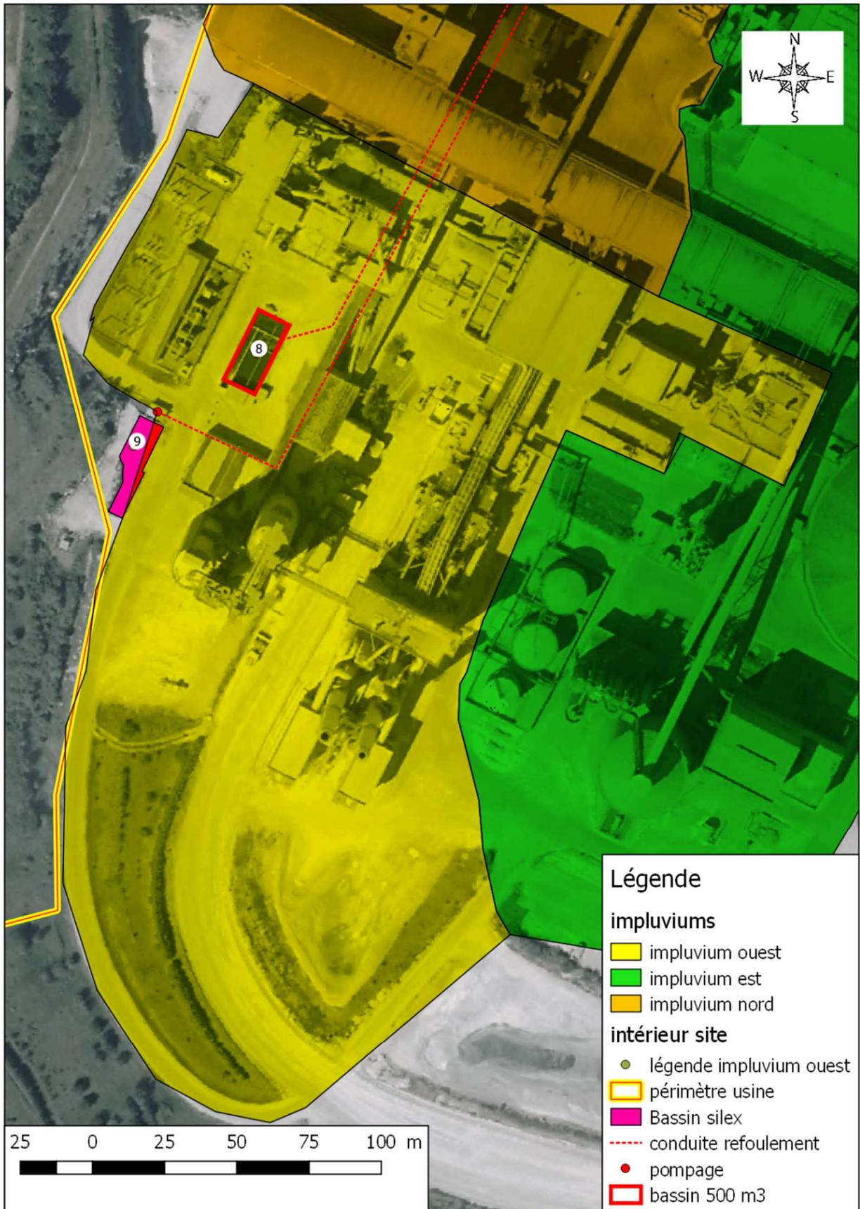
Figure 15 : : localisation des ouvrages de gestion des eaux pluviales de l'impluvium ouest
